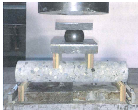
写真-5 曲げ試験供試体
