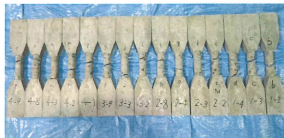
写真-7 25mm コア引張供試体の破壊状況(全体)
