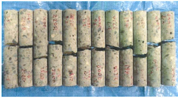
写真-9 50mm コア曲げ供試体の破壊状況(全体)
