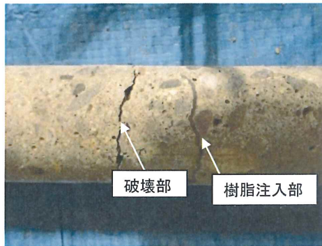
写真-10 50mm コア曲げ供試体の破壊状況(一例)
