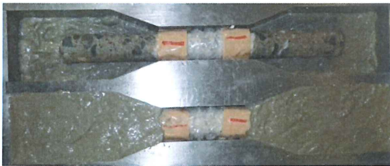
写真-2 型枠で成形中のダンベル型供試体
